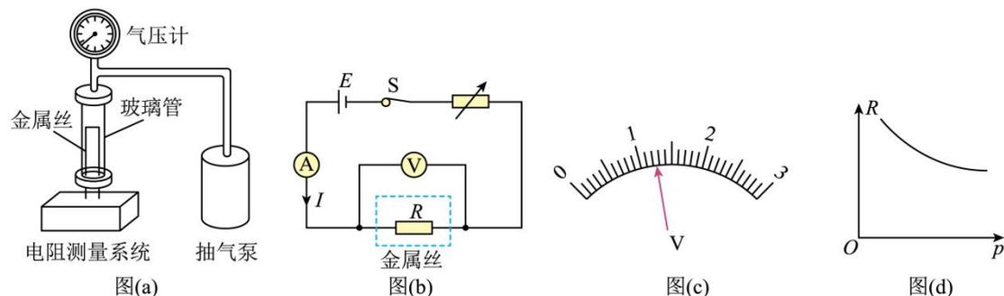
(1) 保持玻璃管内压强为 1 个标准大气压，电流表示数为 100mA，电压表量程为 3V，表盘如图 (c) 所示，示数为 \_\_\_\_\_ V，此时金属丝阻值的测量值  $R$  为 \_\_\_\_\_  $\Omega$  (保留 3 位有效数字)；
