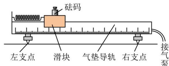
(1) 调平气垫导轨，将弹簧左端连接气垫导轨左端，右端连接滑块；
