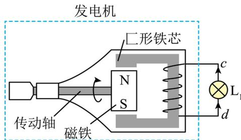
(2) [2]由图可知, 开始阶段, 穿过线圈的磁通量最大, 磁通量的变化率最小, 转动后, 磁通量减小, 磁通量的变化率增大, 当转过  $90^\circ$  时, 穿过线圈的磁通量最小, 磁通量的变化率最大, 可知, 转动过程中  $L_1$  中的电流逐渐增大。
