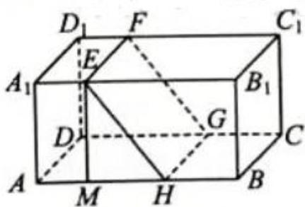
(II) 作  $EM \perp AB$ , 垂足为  $M$ , 则  $AM = A_1E = 4$ ,  $EB_1 = 12$ ,  $EM = AA_1 = 8$ , 因为  $EFGH$  是正方形, 所以  $EH = EF = BC = 10$ , 于是  $MH = \sqrt{EH^2 - EM^2} = 6$ ,  $AH = 10$ ,  $HB = 6$ . 因为长方体被平面  $\alpha$  分成两个高为 10 的直棱柱, 所以其体积比值为  $\frac{9}{7}$  ( $\frac{7}{9}$  也正确).
