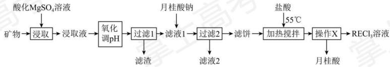
已知：月桂酸( $C_{11}H_{23}COOH$ )熔点为  $44^\circ\text{C}$ ；月桂酸和  $(C_{11}H_{23}COO)_3\text{RE}$  均难溶于水。该工艺条件下，稀土离子保持 +3 价不变； $(C_{11}H_{23}COO)_2\text{Mg}$  的  $K_{sp} = 1.8 \times 10^{-8}$ ， $\text{Al(OH)}_3$  开始溶解时的 pH 为 8.8；有关金属离子沉淀的相关 pH 见下表。
